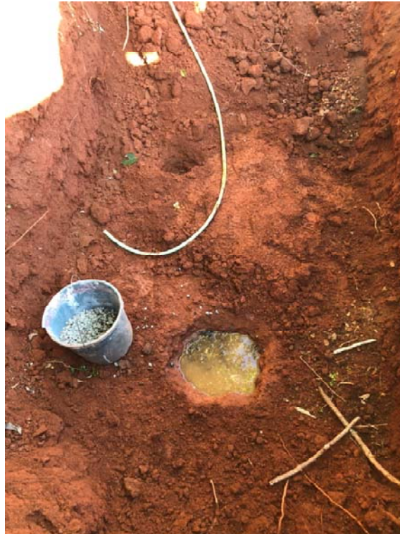
Foto 24: Claumaicon Siqueira e Zuleide Trombeta - PONTO 02 - TESTE DE INFILTRAÇÃO
